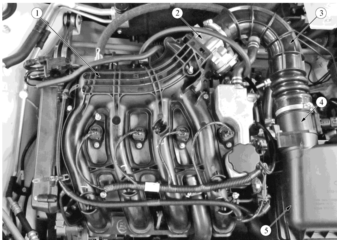
Рис. 1.7-01. Система впуска воздуха двигателя 21126:
