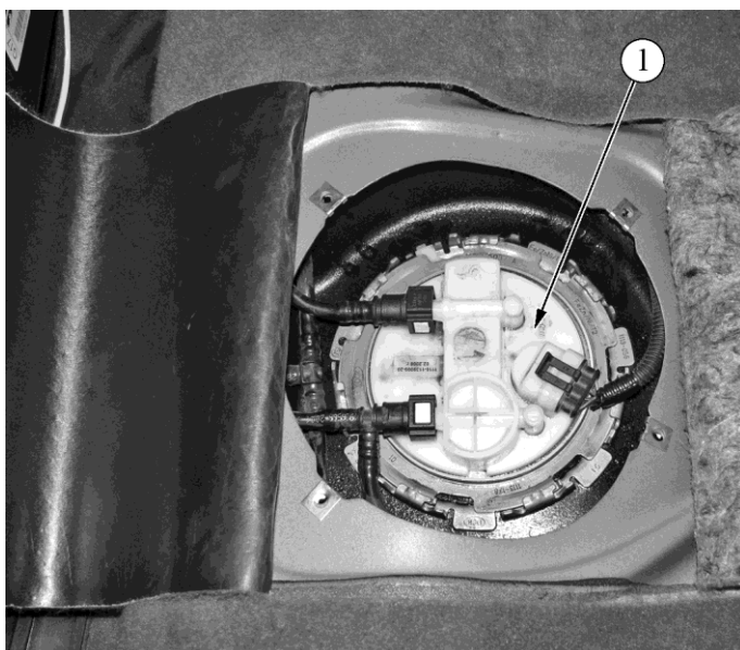
Рис. 1.3-04. Расположение модуля электробензонасоса в салоне автомобилей семейства LADA KALINA:
