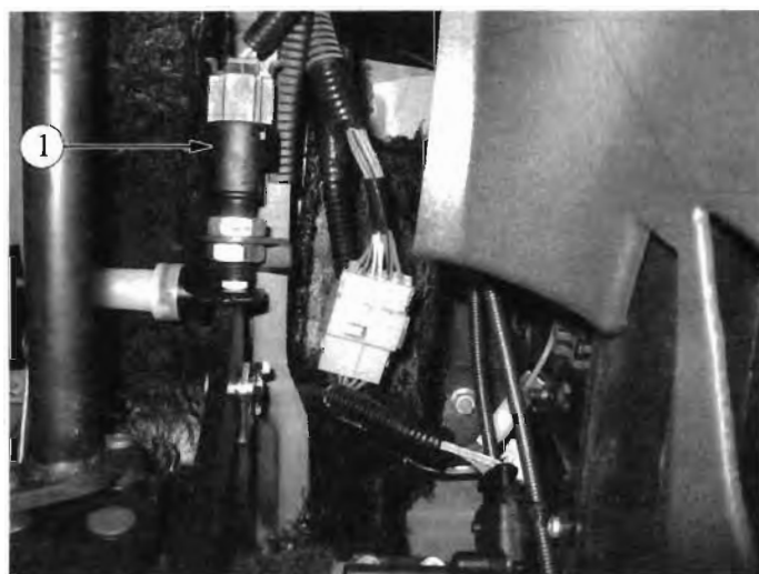
Рис. 1.1-12. Расположение выключателя сигнала торможения в салоне автомобилей семейства LADA SAMARA:
