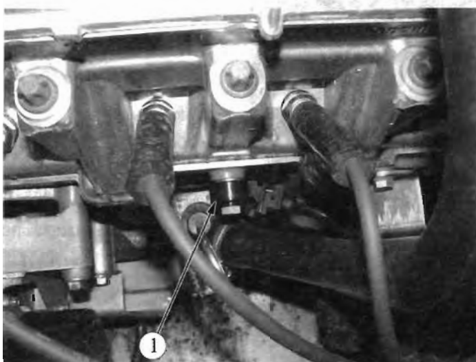
Рис. 1.1-07. Расположение датчика детонации на двигателе 11183: 1 - датчик детонации
