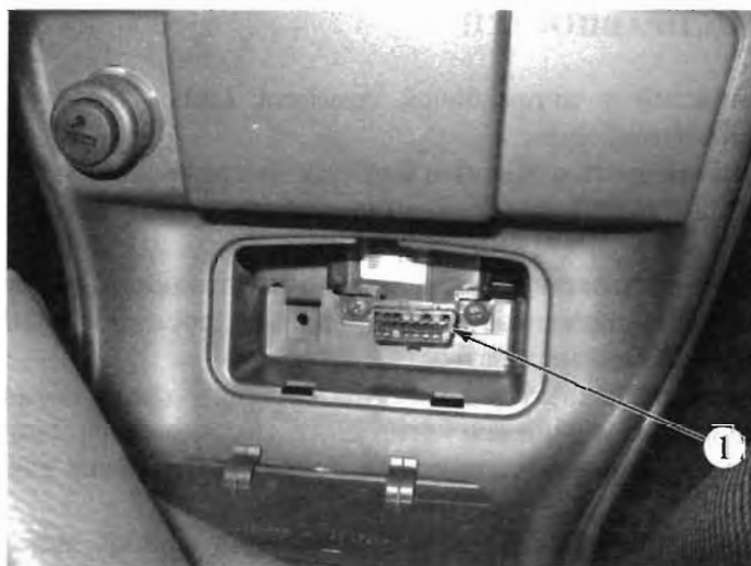
Рис. 2.3-01. Расположение колодки диагностики в салоне автомобилей семейства LADA SAMARA:
