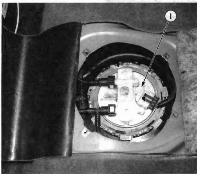
Рис. 1.3-03. Расположение модуля электробензонасоса в автомобилях семейства LADA KALINA: 1 - модуль электробензонасоса
