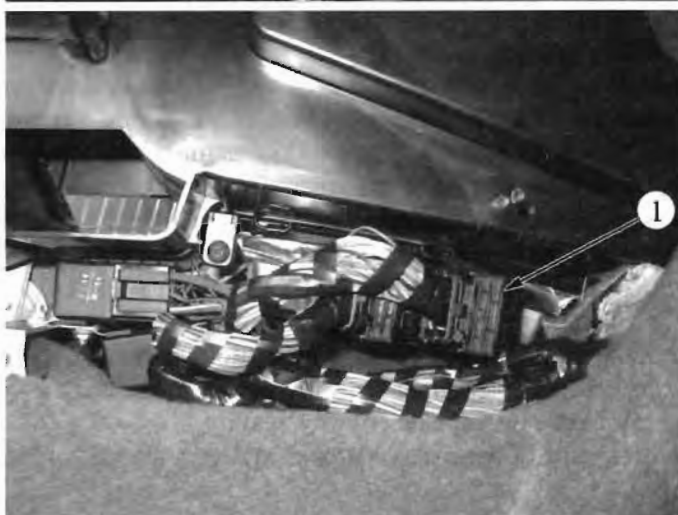
Рис. 1.1-02. Расположение контроллера в салоне автомобилей семейства LADA KALINA: 1 - контроллер
