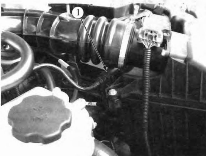
Рис. 1.8-03. Расположение клапана продувки адсорбера на автомобилях семейства LADA KALINA: 1 - клапан продувки адсорбера
