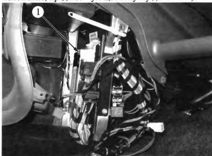
Рис. 1.1-01. Расположение контроллера в салоне автомобилей семейства LADA SAMARA: 1 - контроллер
