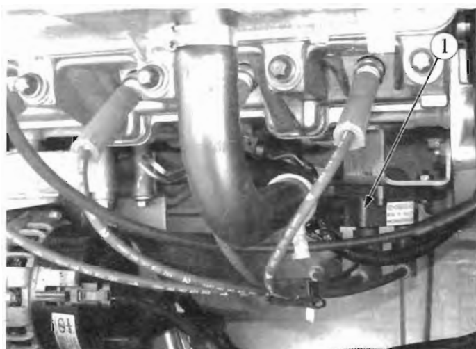
Рис. 1.4-02. Расположение катушки зажигания на двигателе 11183: 1 - катушка зажигания
