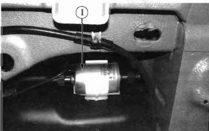
Рис. 1.3-05. Расположение топливного фильтра на автомобилях семейства LADA KALINA (вид снизу):
