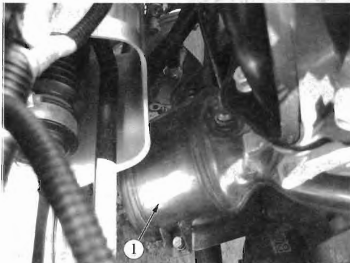
Рис. 1.9-01. Расположение каталитического нейтрализатора на двигателе 11183:
