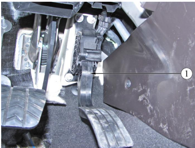
Рис. 1.1-03. Расположение электронной педали акселератора в салоне автомобилей семейства LADA VESTA:
