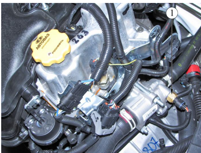
Рис. 1.1-04. Расположение датчика температуры охлаждающей жидкости в подкапотном пространстве автомобилей семейства LADA VESTA:
