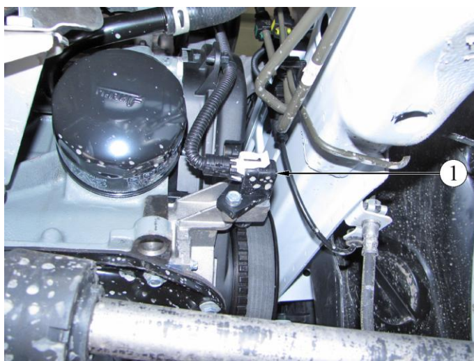
Рис. 1.1-07. Расположение датчика положения коленчатого вала на двигателе 21129:
