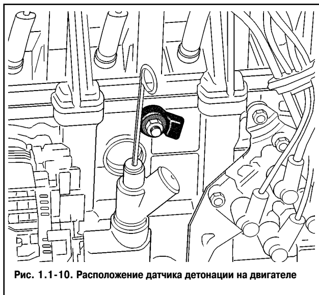
Рис. 1.1-09. Датчик детонации.
